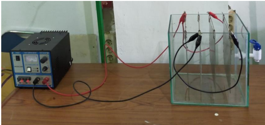
b) Tampak Reaktor Elektrokoagulasi Gambar 3.2. Reaktor elektrokoagulasi
