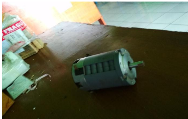
Generator DC 12-18 Volt ,Arus 15 A
