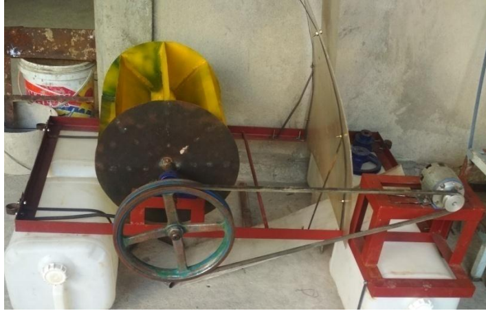
Pemanfaatan Generator Untuk PLTMH
