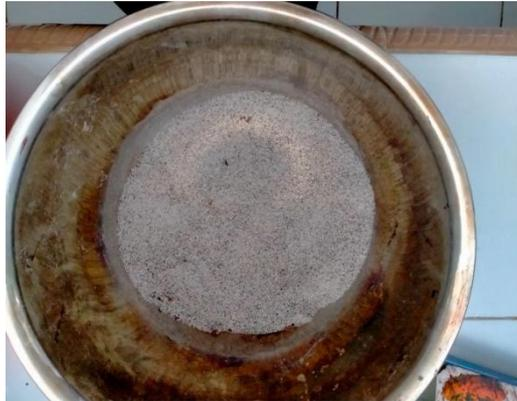
Hasil Pengeringan Adsorben Abu dengan Oven pada Suhu 100°C
