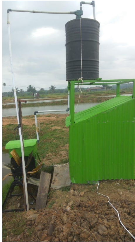
Gambar 4.2 Rancangan Pembangkit Piko Hidro
