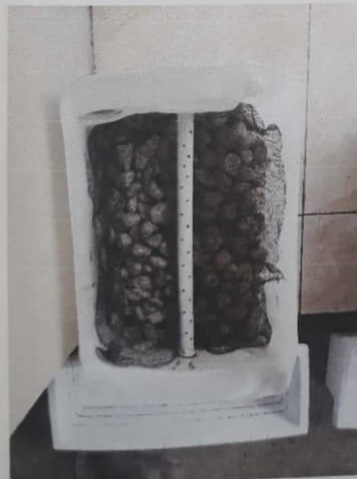
Proses Pemasangan Pipa Pada Bak Reaktor Constructed Wetland
