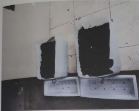
Proses Akhir Siap Tanam Pada Bak Reaktor Constructed Wetland
