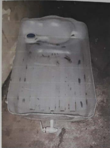
Proses Pembuatan Bak Reaktor Constructed Wetland
