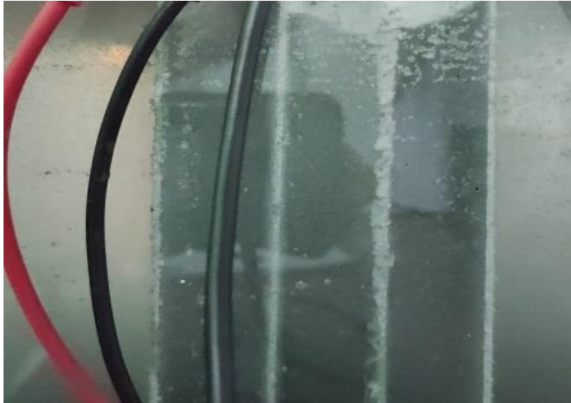
Gambar 4.8 (b) Membentuk flok-flok
