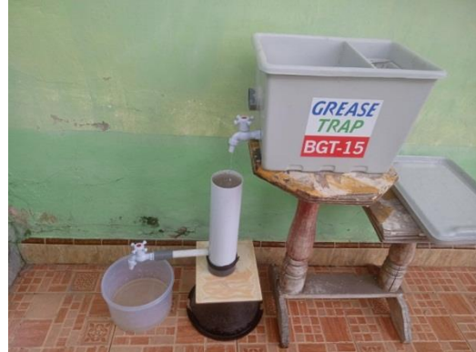
Gambar.10 Gambar Alat Penelitian Menggunakan Grease Trap , Filtrasi Biochar Dan Pasir
