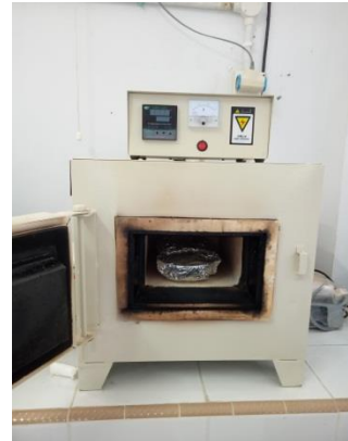
Gambar.2 Proses Karbonisasi Tatal Karet Menggunakan Furnace
