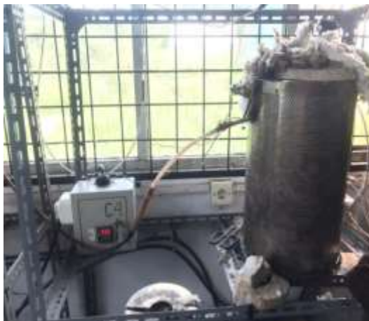
Gambar 3.3 Furnance (Pirolisator) Sumber : Dokumentasi, 2021
