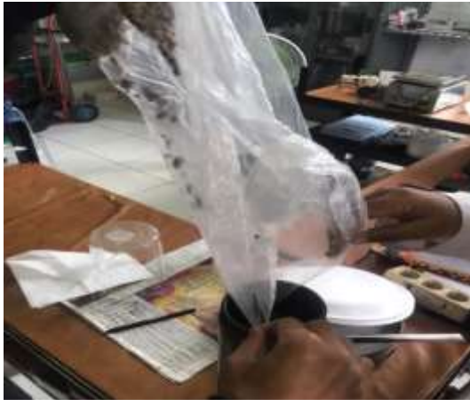
Memasukkan Tatal Karet kedalam alat pirolisis
