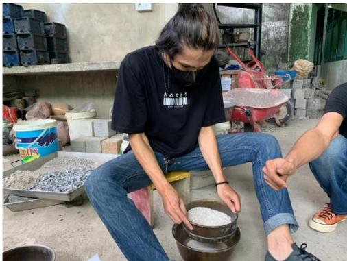
Proses Penyaringan Agregat
