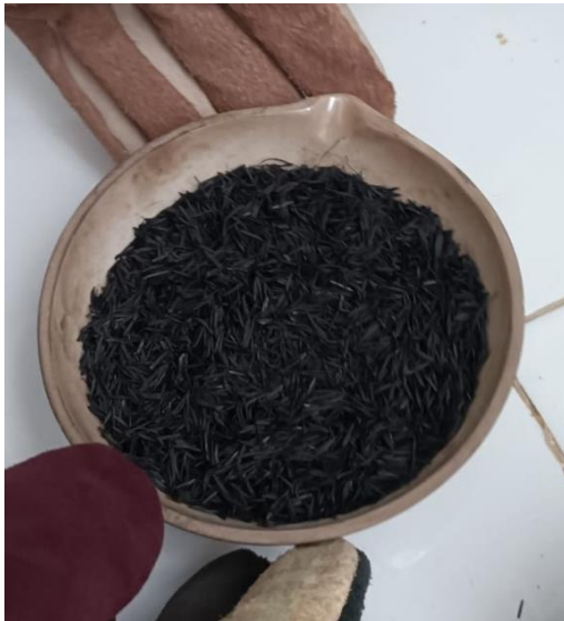
Gambar 4.3 Arang Sekam Padi Setelah Di Furnace (Hasil Penelitian; 2022)
