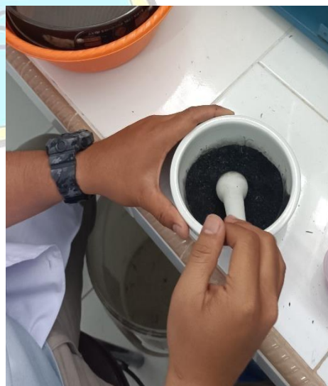
Proses Penumbukkan Sekam Padi Sampai Ukuran 40 Mesh
