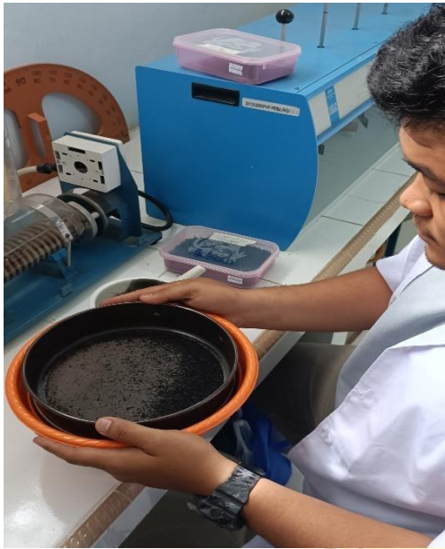
Proses Pengayakan Menggunakan Ayakan Ukuran 40 Mesh
