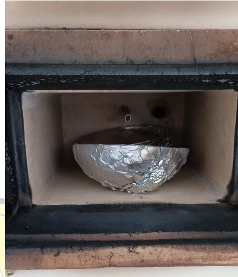
Proses Karbonisasi Sekam Padi di Furnace Dengan suhu 400°C
