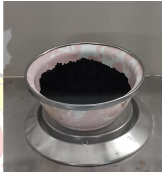
Gambar 4.4 Bioadsorben sekam padi Setelah Diayak 40 Mesh (Hasil Penelitian; 2022)
