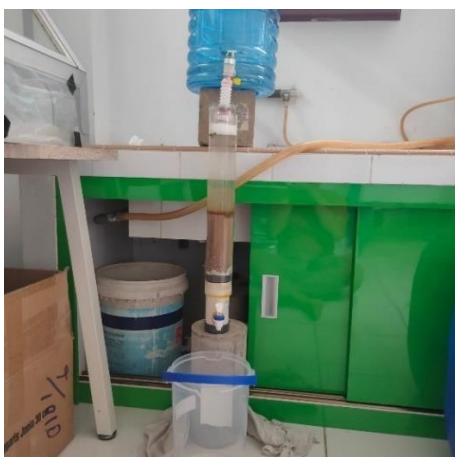
Gambar 9. Sampel saat dilakukan soil washing menggunakan leaching column
