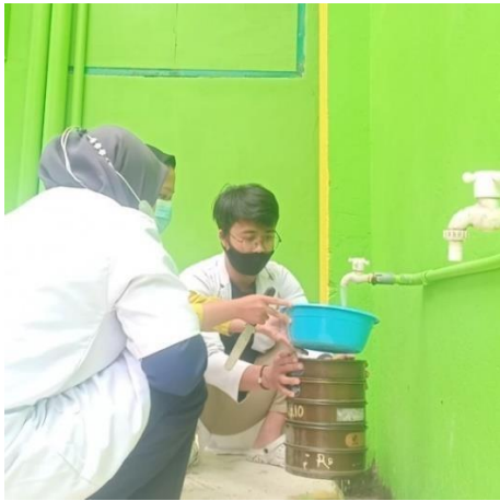
Gambar 1. Melakukan Penyaringan basah untuk pengujian grain size
