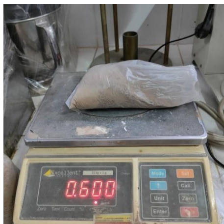
Gambar 6. Penimbangan sampel tanah
