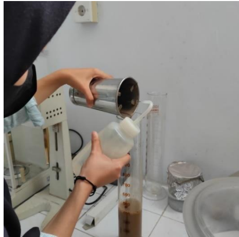
Gambar 4. Penambahan volume air 900ml untuk pengujian hidrometer
