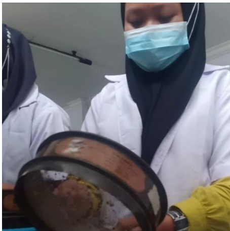
Gambar 2. Memasukan partikel tanah yang tertahan pada saringan ke cawan
