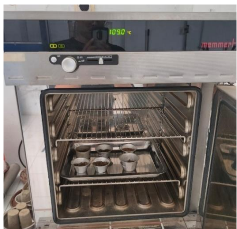
Gambar 12. Pengeringan sampel setelah soil washing
