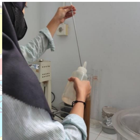
Gambar 5. Pengocokan 60 kali untuk pengujian hidrometer
