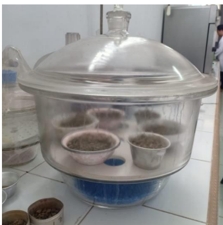
Gambar 3. Sampel tanah didinginkan menggunakan desikator
