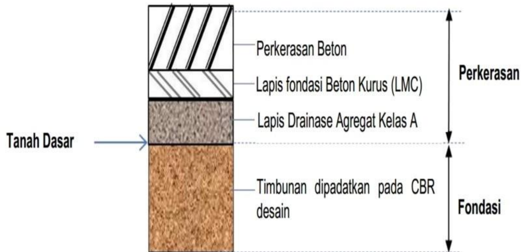
Gambar 2.4 Struktur perkerasan kaku pada timbunan
