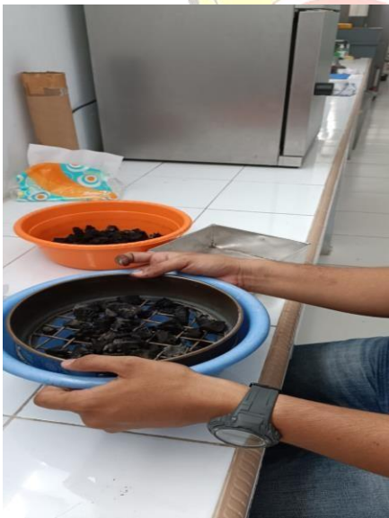
Proses karbonisasi kulit durian di furnace suhu 400°C
