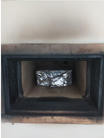
Proses karbonisasi kulit durian di furnace suhu 400°C
