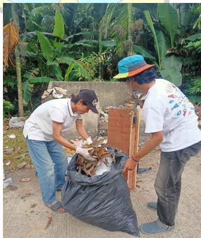
Gambar 4.3 Pengukuran volume dan komposisi sampah
