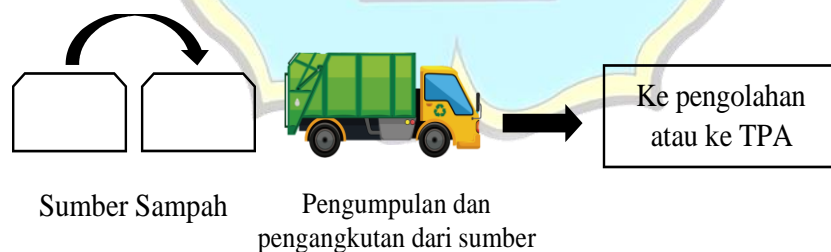
Gambar 2.3 Skema pengumpulan dan pengangkutan individual langsung
