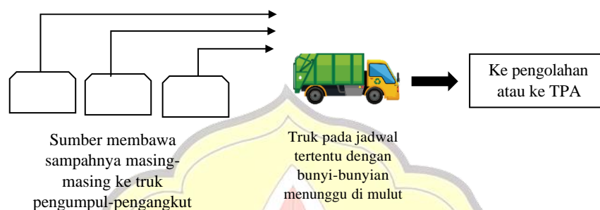
Gambar 2.5 Skema pengumpulan dan pengangkutan komunal langsung
