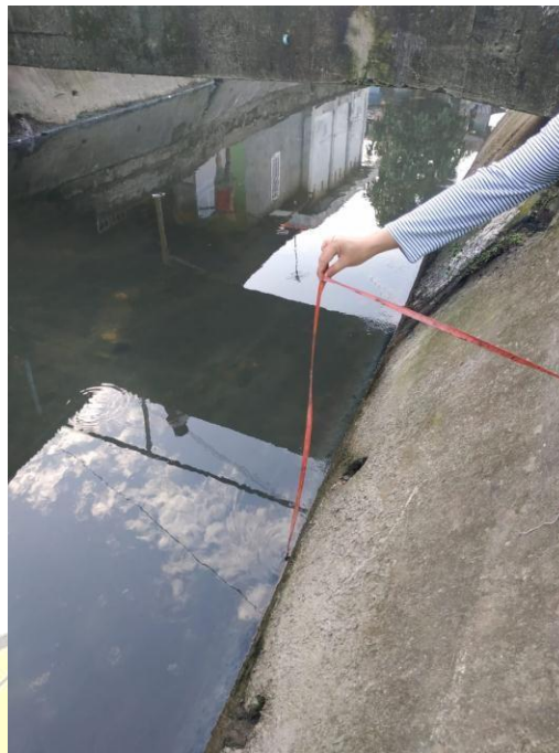
Gambar 3. Pengukuran Tinggi pada Drainase Penelitian yang Berbentuk Trapesium.
