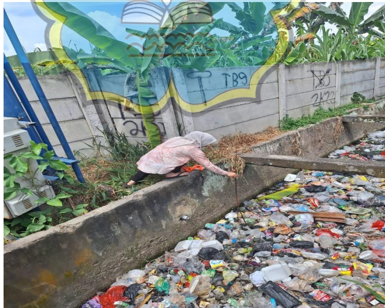
Gambar 2. Pengukuran Lebar Bagian Bawah pada Drainase Penelitian yang Berbentuk Persegi Panjang
