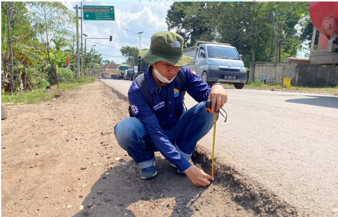
Gambar 8 Foto Pengukuran Ketebalan Badan Jalan
