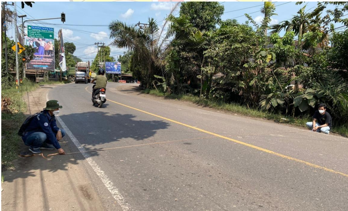
Gambar 4 Foto Pengukuran Lebar Badan Jalan
