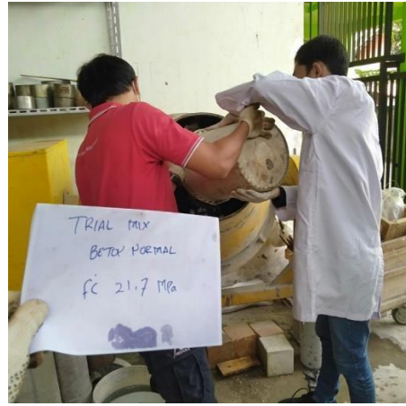
Masukkan semua material ke dalam mesin molen
