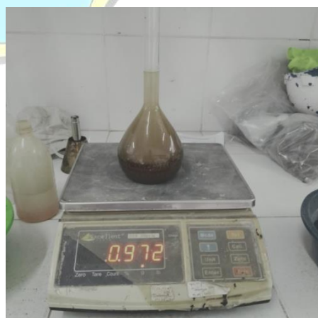
Berat piknometer + air + contoh percobaan 2
