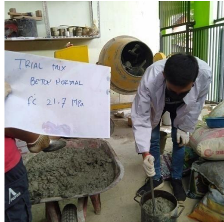
Lakukan pengujian berat isi beton segar
