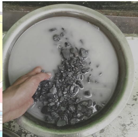
Cuci agregat tertahan saringan No. 12 hingga bersih
