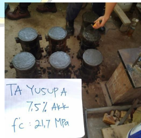
Ratakan permukaan silinder
