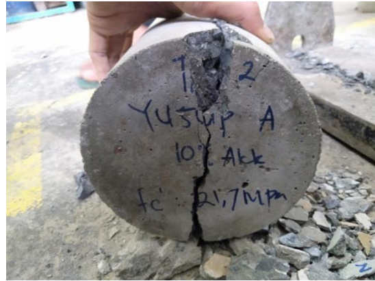
Bentuk kehancuran benda uji 2
