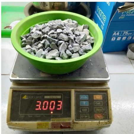
Timbang agregat setelah dikeringkan
