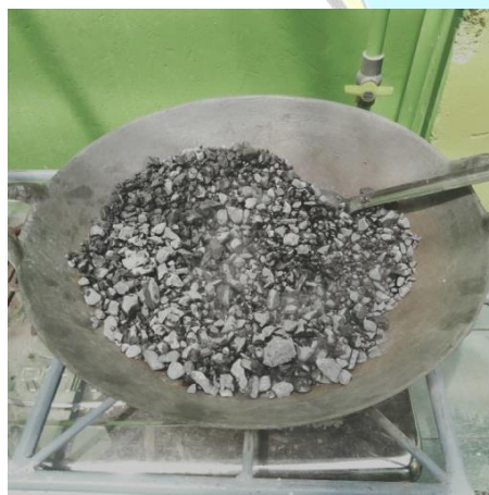
Keringkan agregat di atas kompor
