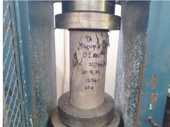
Bentuk kehancuran benda uji 3
