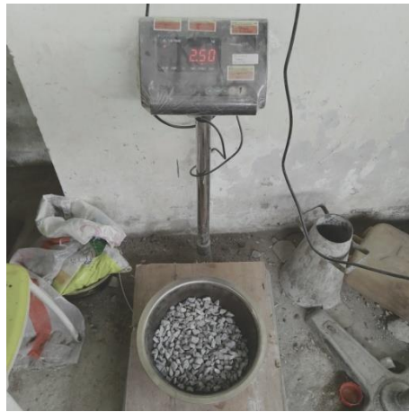
Timbang agregat tertahan saringan 1/2 sebanyak 2500 gr
