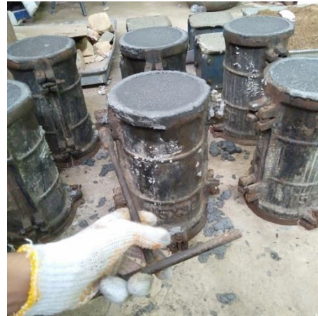
Beton yang sudah mengeras kemudian dikeluarkan dari cetakan silinder
