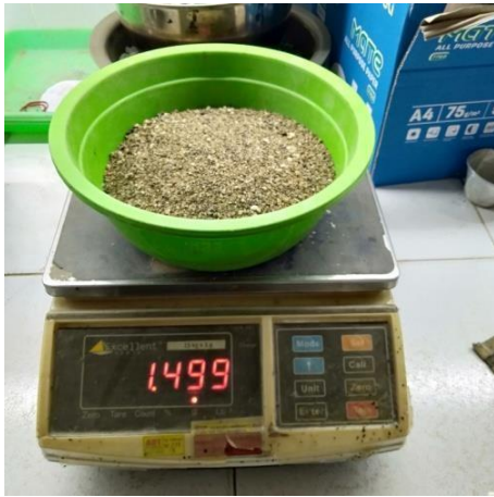
Timbang agregat halus awal dalam keadaan normal
