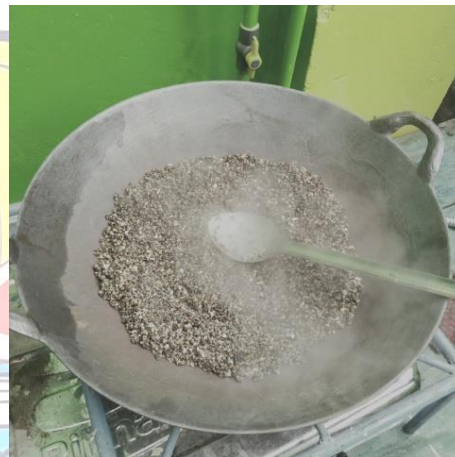
Keringkan agregat di atas kompor
