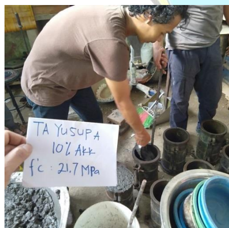
Masukkan beton segar ke dalam cetakan silinder
