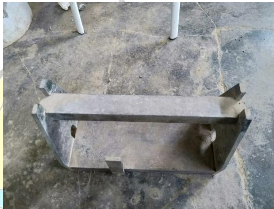
Gambar 2.2 Alat Uji Kuat Tarik Belah Beton
