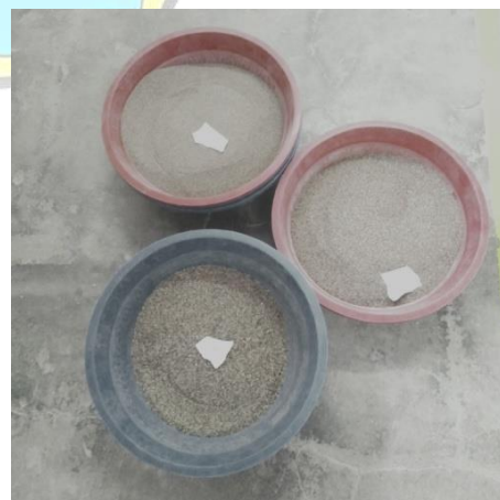
Agregat yang tertahan tiap masing-masing nomor saringan
