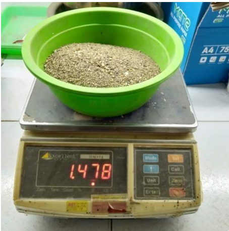
Timbang agregat halus yang telah dikeringkan
