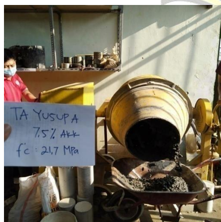
Keluarkan beton segar dari dalam molen
