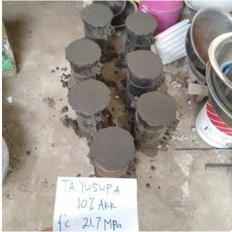
Tunggu ±24 jam hingga beton mengeras
