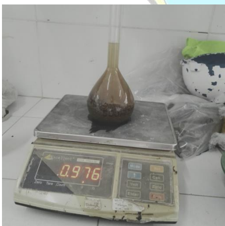
Berat piknometer + air + contoh percobaan 1
