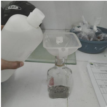
Masukkan larutan NaOH 3% hingga benda uji terendam
