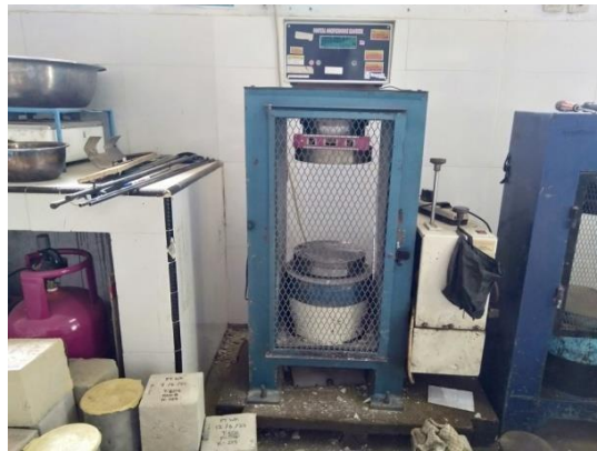
Gambar 2.1 Mesin Pengujian Kuat Tekan
