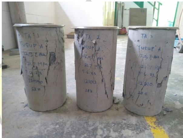
Perbandingan bentuk kehancuran benda uji
