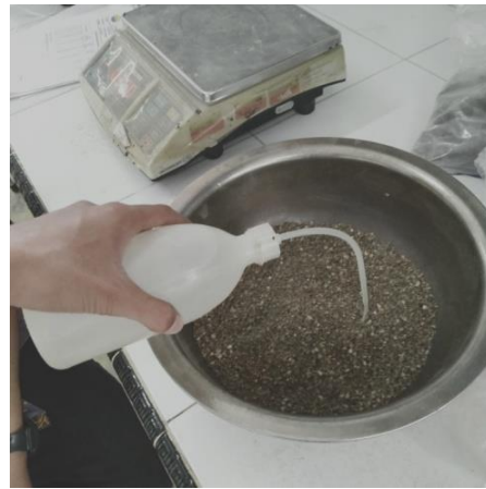
Tambahkan air pada agregat halus hingga kondisi JKP
