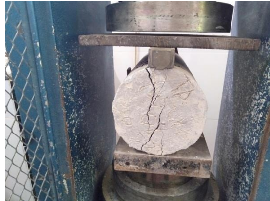
Bentuk kehancuran benda uji 2
