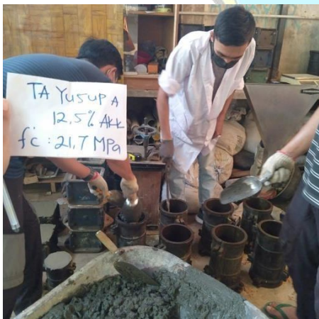
Masukkan beton segar ke dalam cetakan silinder
