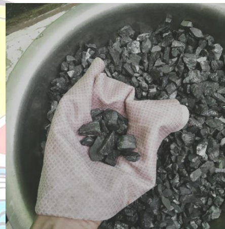
Lap agregat hingga kondisi jenuh kering permukaan
