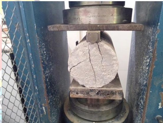
Bentuk kehancuran benda uji 1
