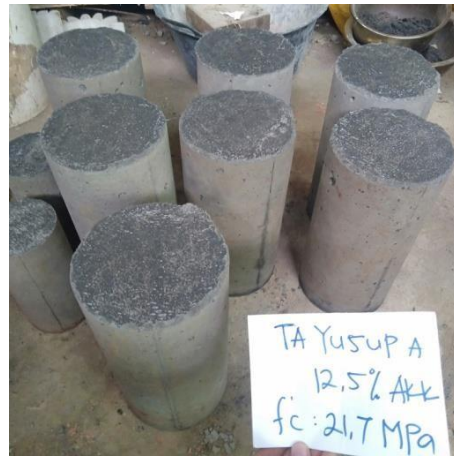
Beton yang telah dikeluarkan dari cetakan silinder
