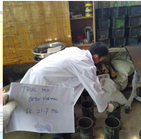
Masukkan beton segar ke dalam cetakan silinder
