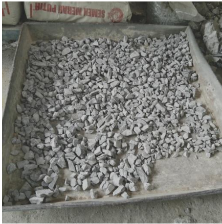
Siapkan agregat kasar yang telah dikeringkan
