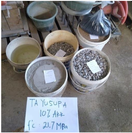
Siapkan semua material untuk pengecoran beton 10 % AKK
