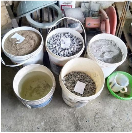
Siapkan semua material untuk pengecoran beton normal
