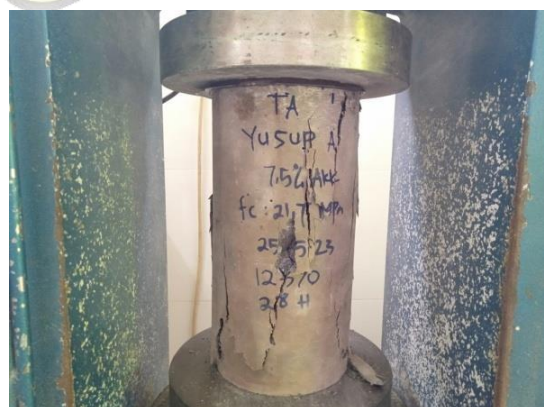
Bentuk kehancuran benda uji 1
