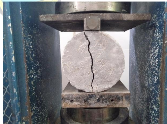
Bentuk kehancuran benda uji 3
