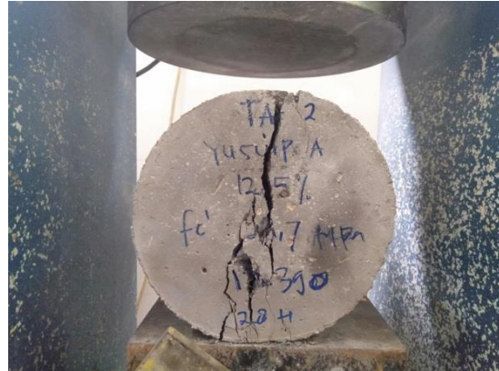
Bentuk kehancuran benda uji 2
