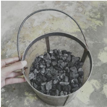
Masukkan agregat ke dalam keranjang kawat
