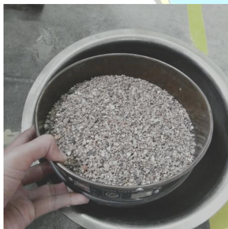
Lakukan penyaringan dengan saringan No. 20
