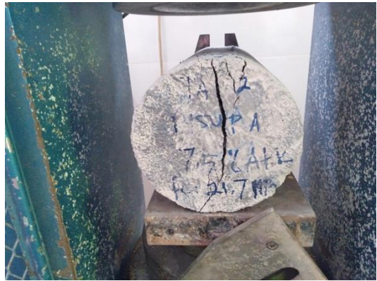
Bentuk kehancuran benda uji 2
