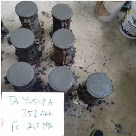
Tunggu ±24 jam hingga beton mengeras
