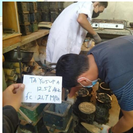
Ratakan permukaan silinder
