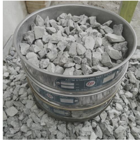
Lakukan penyaringan dan pisahkan agregat yang tertahan tiap saringan
