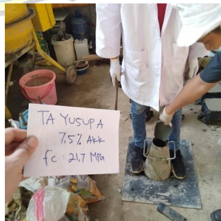
Lakukan pengujian slump
