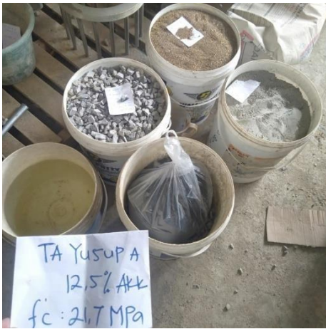
Siapkan semua material untuk pengecoran beton 12,5 % AKK
