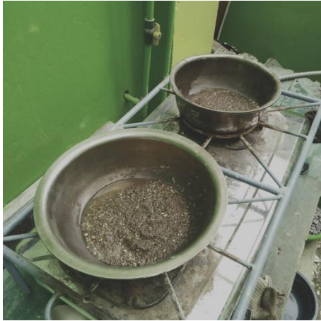
Keringkan agregat halus di atas kompor
