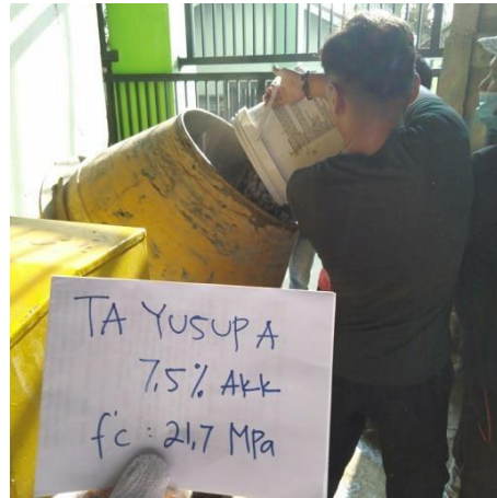
Masukkan semua material ke dalam mesin molen
