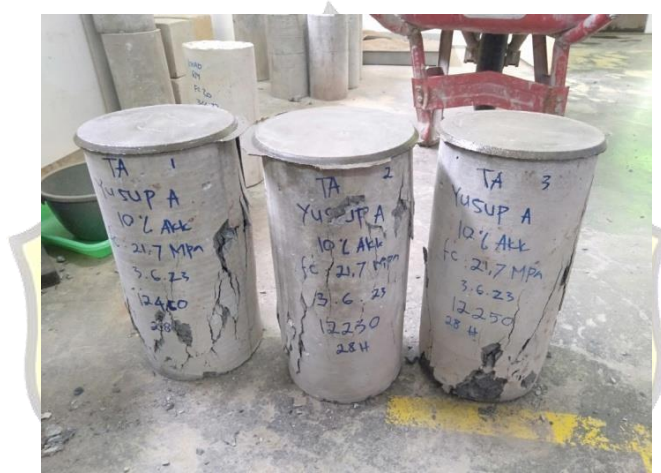
Perbandingan bentuk kehancuran benda uji
