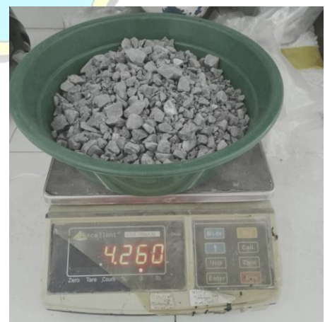
Timbang agregat yang telah kering
