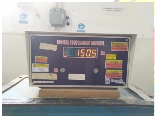
Hasil pengujian benda uji 1
