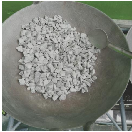
Keringkan agregat di atas kompor
