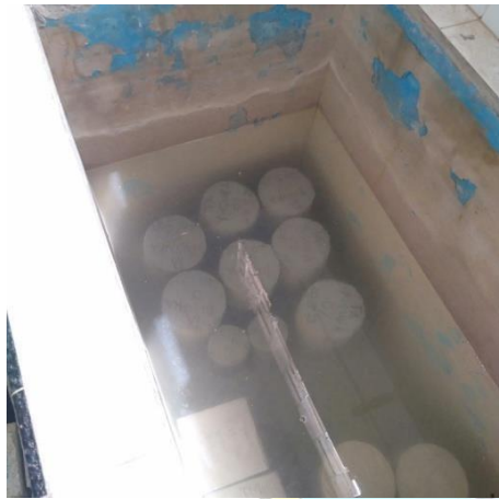
Lakukan perendaman untuk perawatan beton
