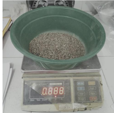
Timbang berat agregat yang tertahan setiap nomor saringan
