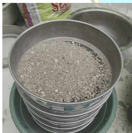
Lakukan penyaringan agregat
