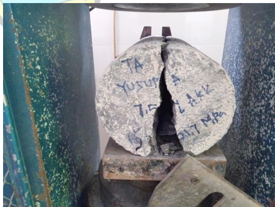
Bentuk kehancuran benda uji 3
