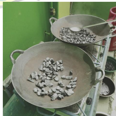
Keringkan agregat di atas kompor
