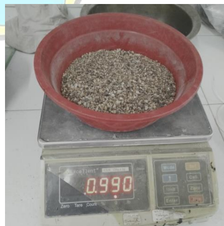
Timbang agregat halus tertahan saringan No. 20
