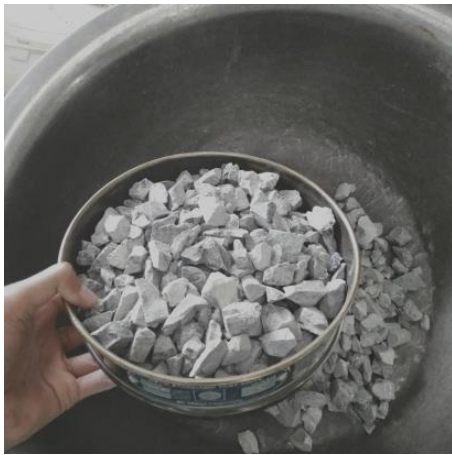
Siapkan agregat kasar yang tertahan saringan No. 4
