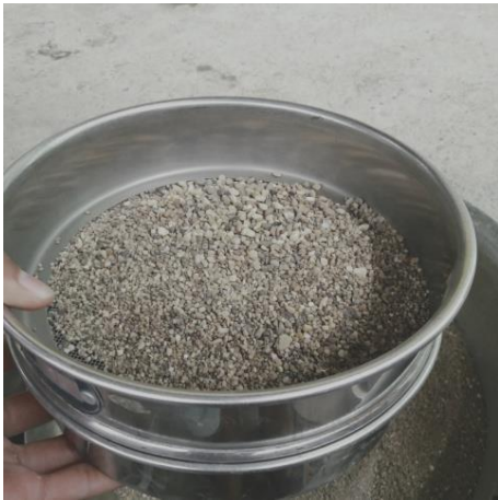
Siapkan agregat halus tertahan saringan No. 16
