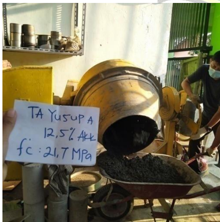
Keluarkan beton segar dari dalam molen
