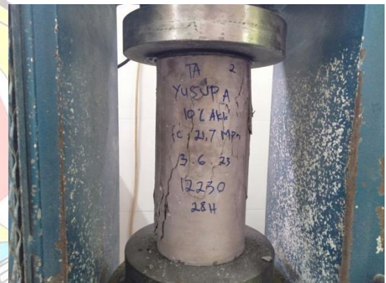
Bentuk kehancuran benda uji 2
