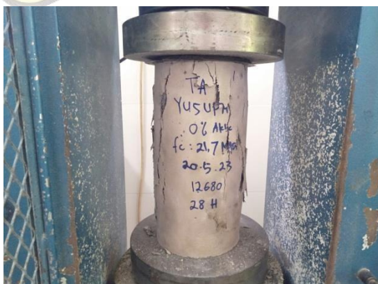
Bentuk kehancuran benda uji 1
