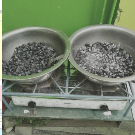
Keringkan agregat di atas kompor
