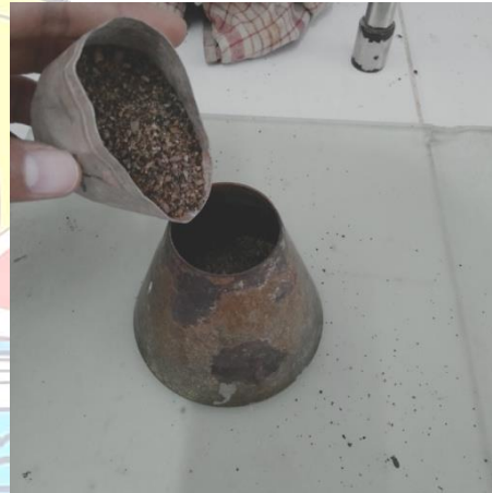
Masukkan agregat ke dalam kerucut terpancung
