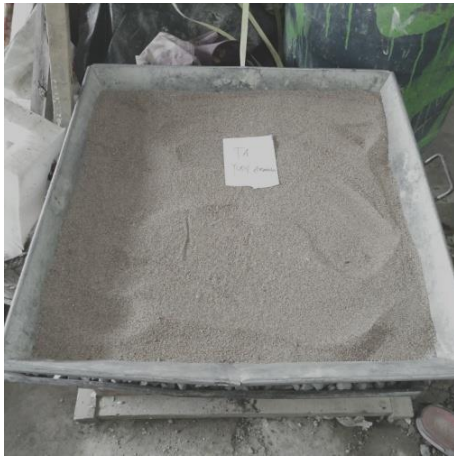
Siapkan agregat halus yang telah dikeringkan
