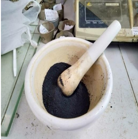
Akk yang masih kasar digiling dan disaring ulang
