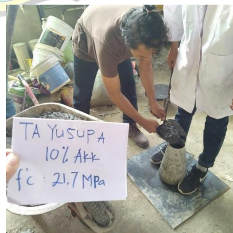
Lakukan pengujian slump
