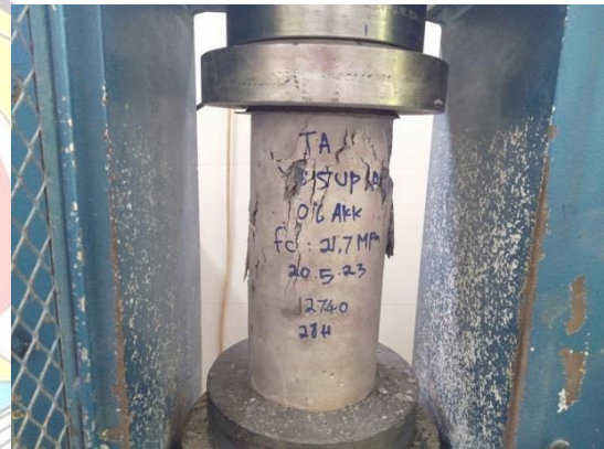
Bentuk kehancuran benda uji 2
