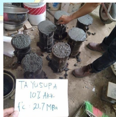
Ratakan permukaan silinder
