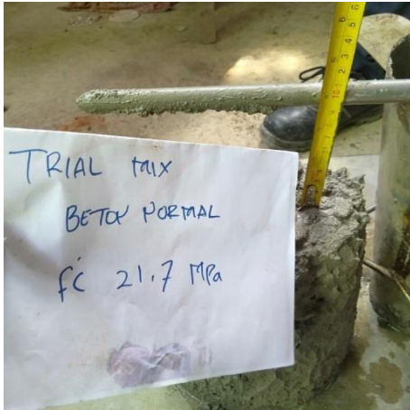
Hasil slump yang didapatkan yaitu 9 cm
