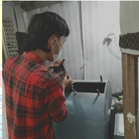
Masukkan agregat ke dalam mesin abrasi
