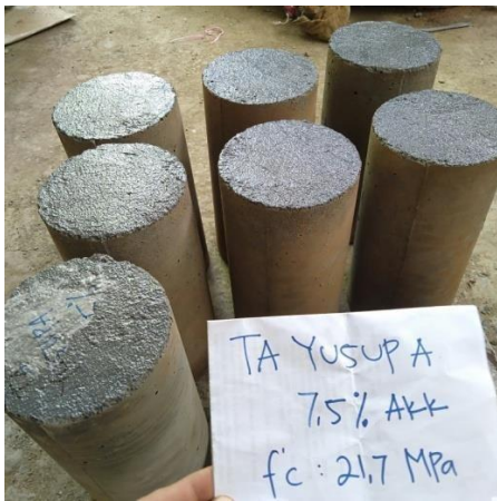
Beton yang telah dikeluarkan dari cetakan silinder
