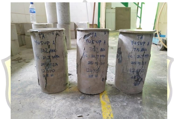
Perbandingan bentuk kehancuran benda uji
