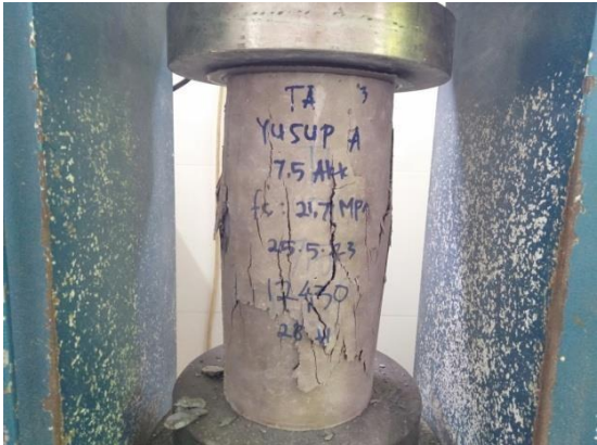
Bentuk kehancuran benda uji 3
