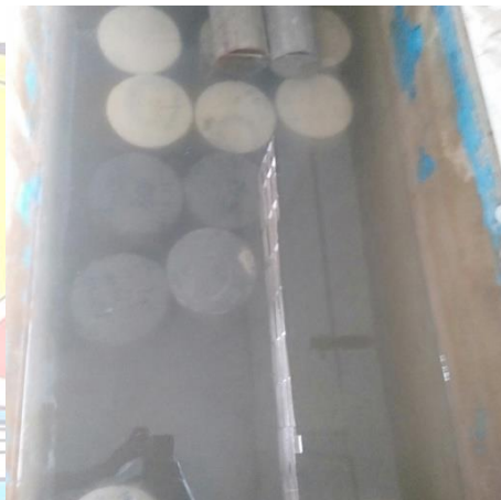
Lakukan perendaman untuk perawatan beton
