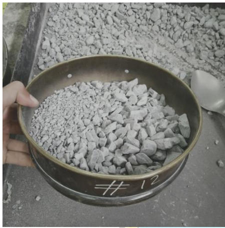
Lakukan penyaringan dengan saringan No. 12
