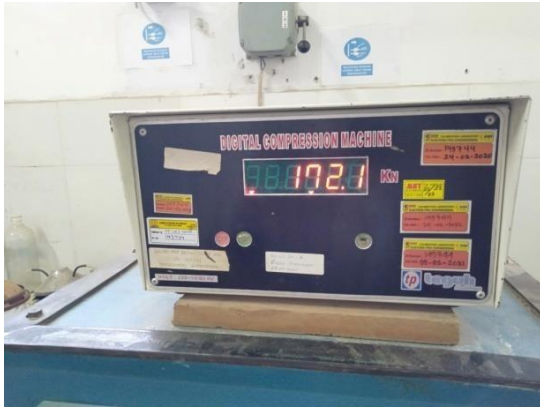
Hasil pengujian benda uji 2
