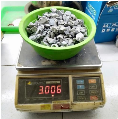
Timbang agregat awal dalam keadaan normal
