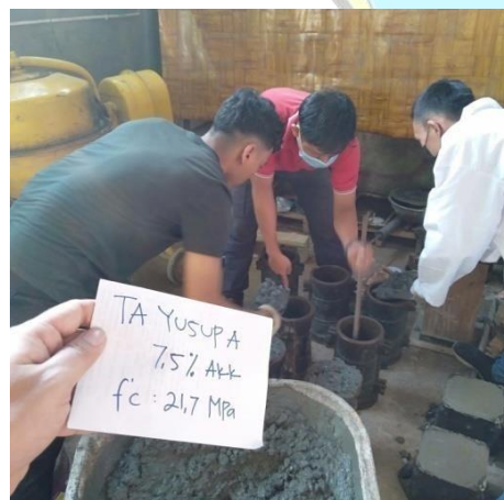
Masukkan beton segar ke dalam cetakan silinder
