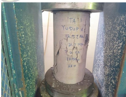
Bentuk kehancuran benda uji 1
