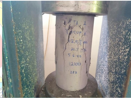
Bentuk kehancuran benda uji 2
