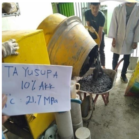
Keluarkan beton segar dari dalam molen
