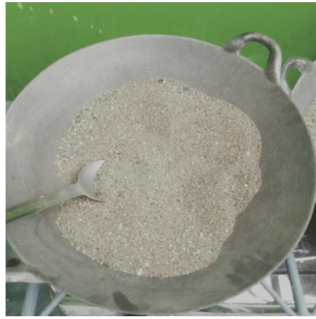
Keringkan agregat halus di atas kompor
