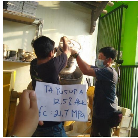
Masukkan semua material ke dalam mesin molen
