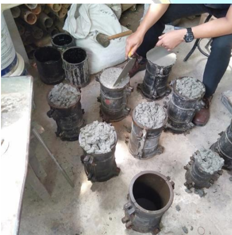
Ratakan permukaan silinder
