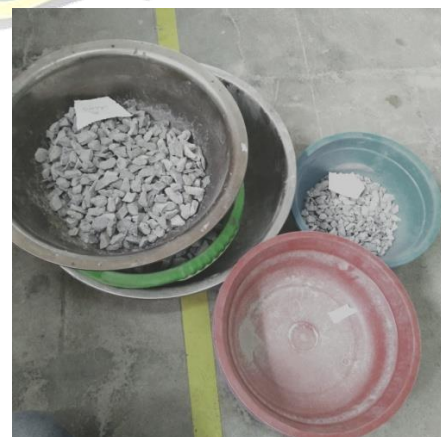
Agregat yang tertahan tiap masing-masing nomor saringan
