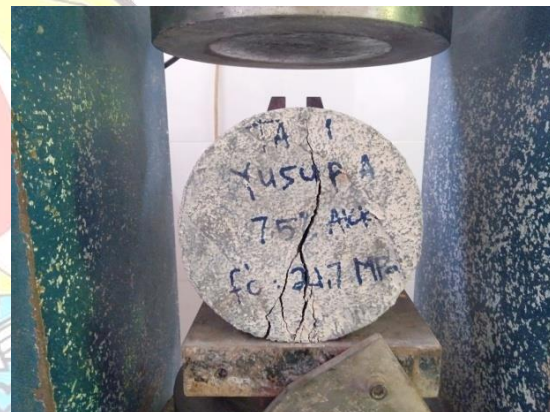
Bentuk kehancuran benda uji 1
