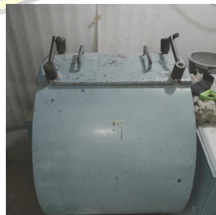
Tutup mesin abrasi
