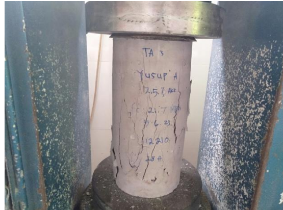
Bentuk kehancuran benda uji 3
