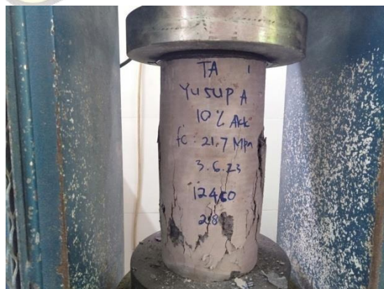
Bentuk kehancuran benda uji 1
