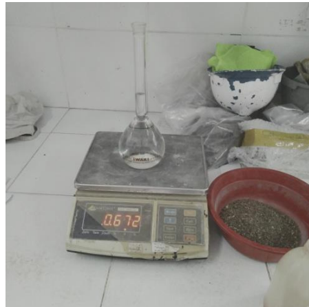
Timbang berat piknometer + air
