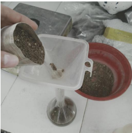
Masukkan agregat halus ke dalam piknometer
