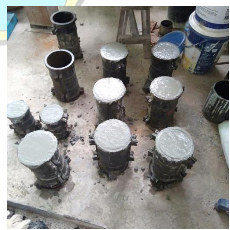
Tunggu ±24 jam hingga beton mengeras
