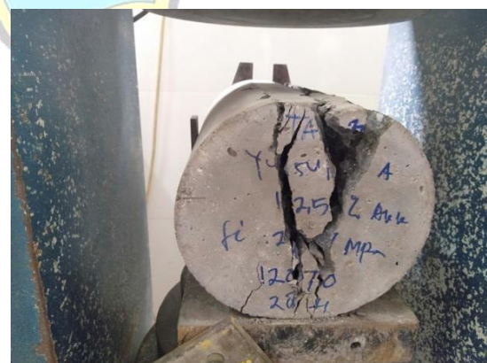
Bentuk kehancuran benda uji 3
