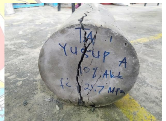
Bentuk kehancuran benda uji 1
