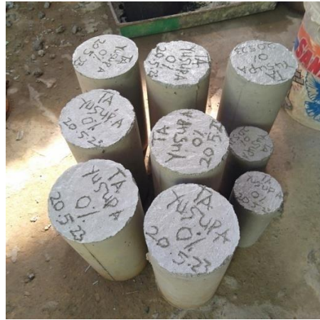
Beton yang telah dikeluarkan dari cetakan silinder
