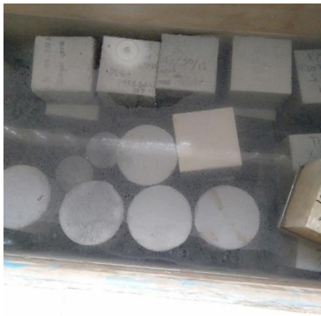
Lakukan perendaman untuk perawatan beton
