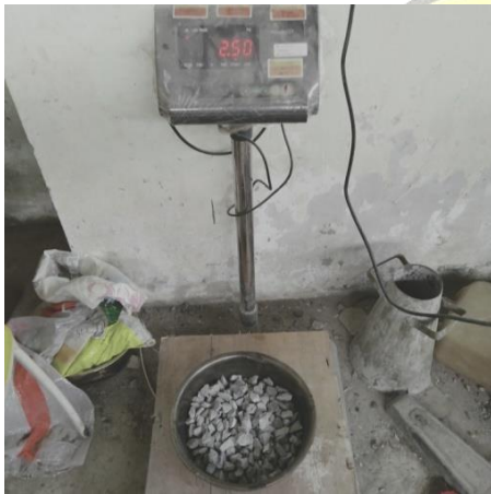
Timbang agregat tertahan saringan 3/8 sebanyak 2500 gr
