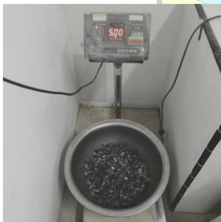
Timbang agregat JKP sebanyak 500 gr
