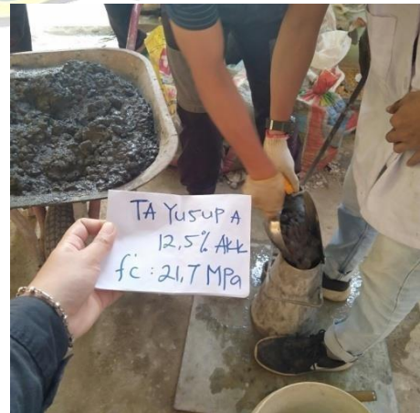
Lakukan pengujian slump
