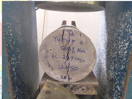
Bentuk kehancuran benda uji 1
