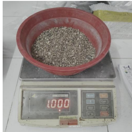
Timbang agregat sebanyak 1000 gr
