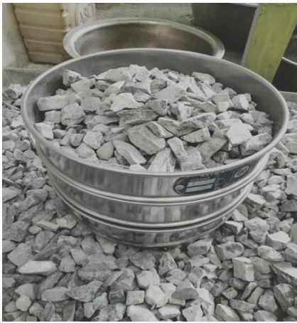
Lakukan penyaringan agregat
