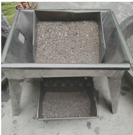
Lakukan quartering untuk mengambil agregat yang akan disaring
