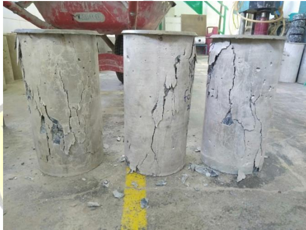
Perbandingan bentuk kehancuran benda uji
