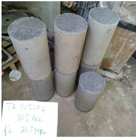
Beton yang telah dikeluarkan dari cetakan silinder
