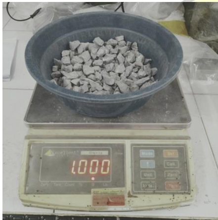
Timbang masing-masing agregat sebanyak 1000 gr
