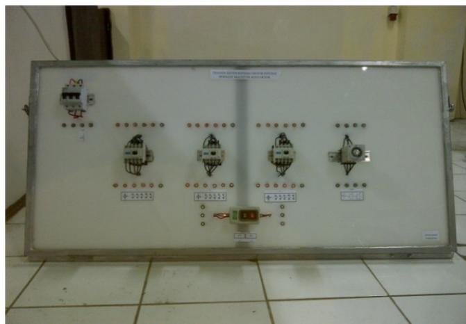
**Gambar 4.2** *Trainer Simtem Kendali Motor Induksi Berbasis Magnetik Kontaktor*
