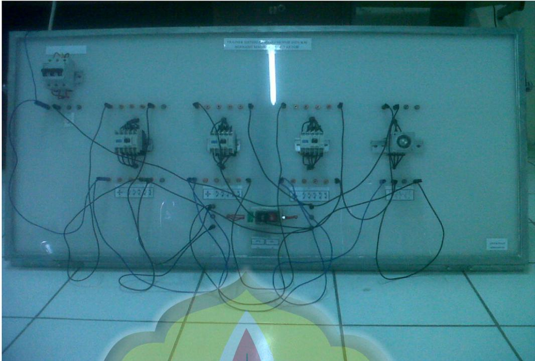
**Gambar.** *Pengujian rangkaian star-delta.*
