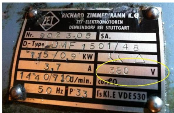
**Gambar 4.3** Contoh Nama Plate Motor 380V
