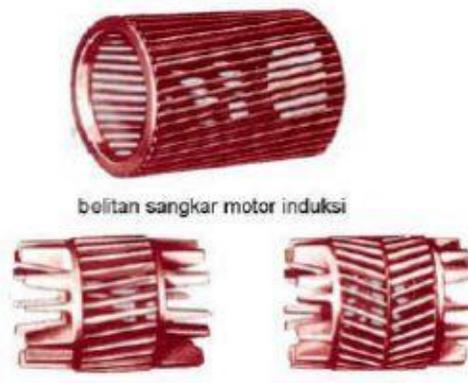
**Gambar 2.2 Rotor Tipe Sangkar**
