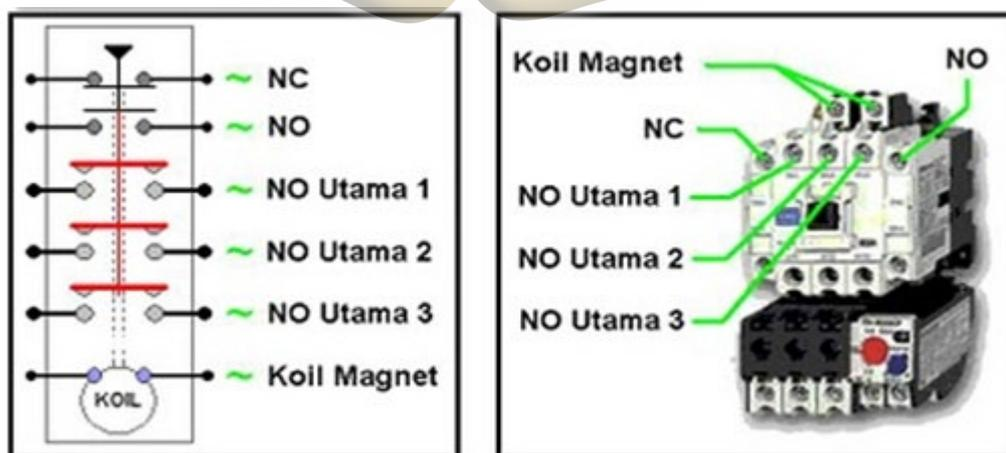
Gambar 1.3 kontak internal pada kontaktor
