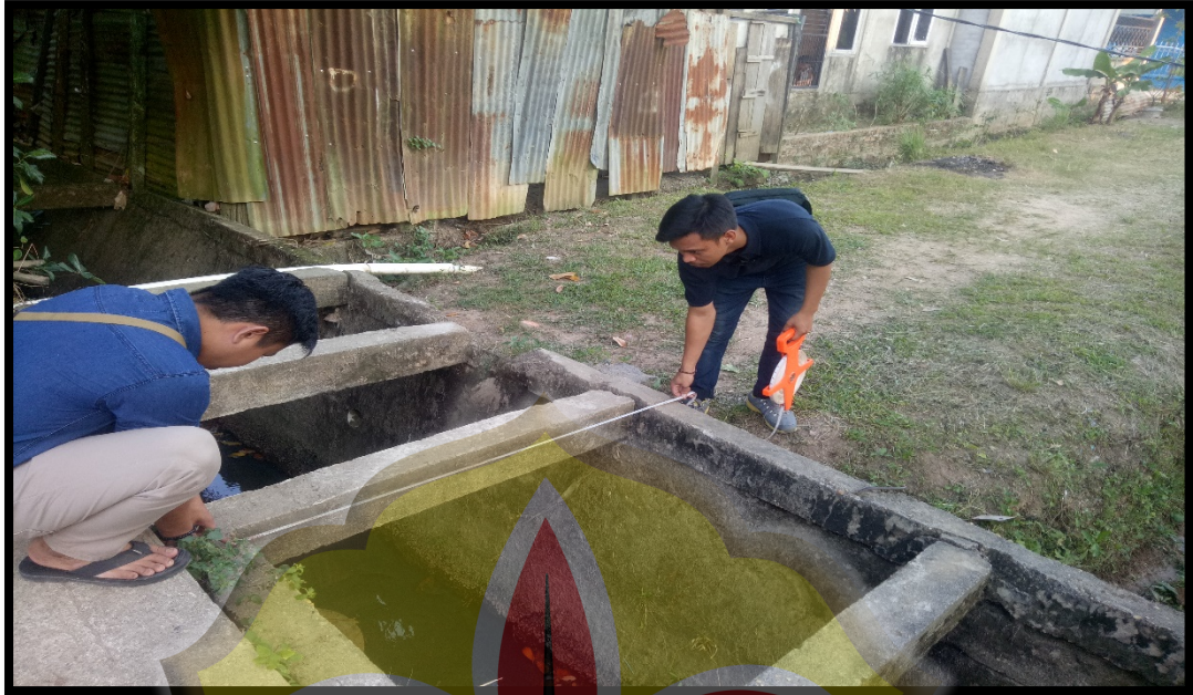
Gambar 5 : Pengukuran Lebar Saluran Drainase
