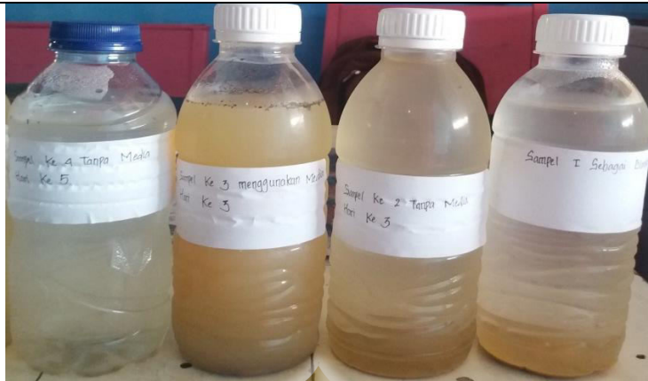
Sampel lumpur IPA PDAM setelah dilakukan proses fitoremediasi
