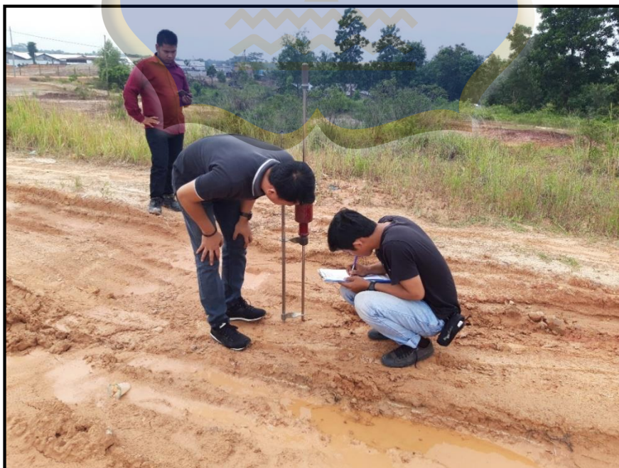
Gambar VI. Proses CBR dengan alat DCP
