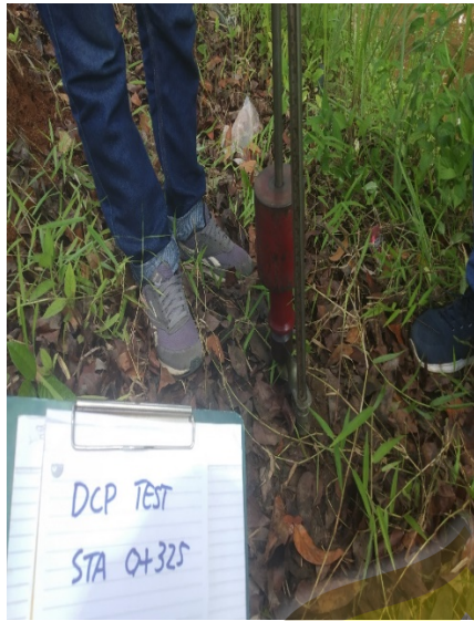
DCP Test STA 0+325
