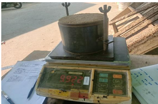
Menimbang Contoh Uji + Cetakan
