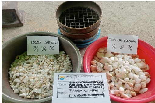
Persiapan Sampel Yang Akan Di Uji
