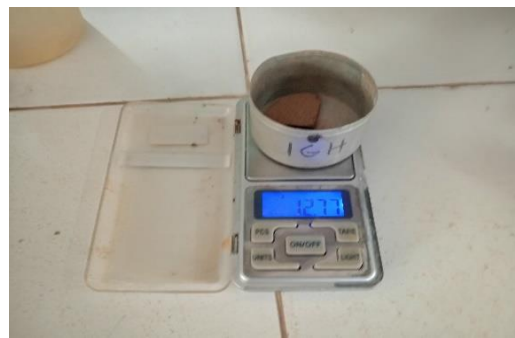
Menimbang Kembali Setelah Dikeringkan
