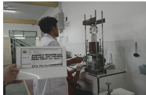
Pengujian Penetrasi CBR Laboratorium
