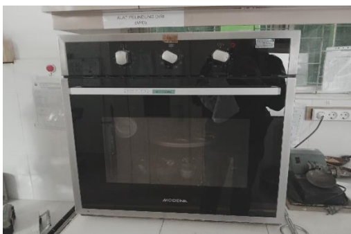
Oven Untuk Mengeringkan Benda Uji
