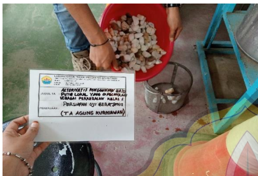
Persiapan Menimbang Dalam Air
