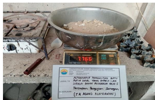
Penimbangan Material Yang Digunakan
