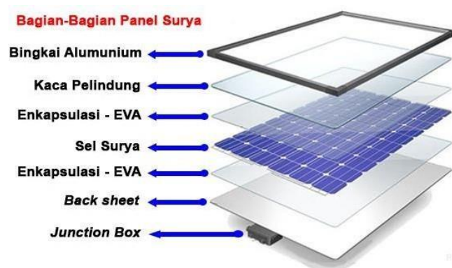
Gambar 2.5 Sturuktur Modul Panel Surya Sumber (GESAINTECH.com)
