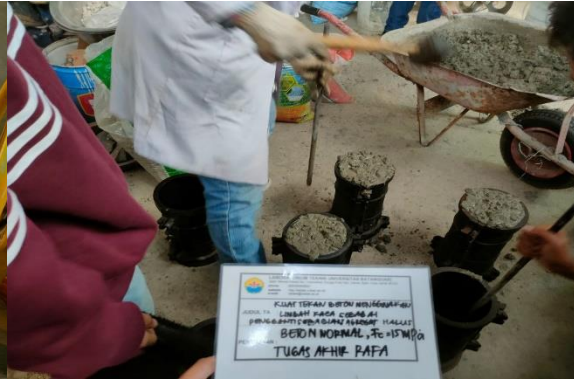
Proses Memasukan Beton Normal Ke Dalam Cetakan Silinder
