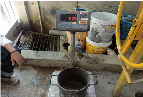
Gambar 1. Penimbangan Kontainer Agregat Kasar
