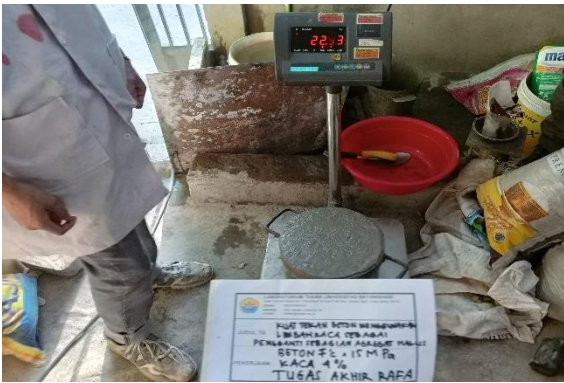
Proses Pengujian Berat Isi Beton Kaca 4 %
