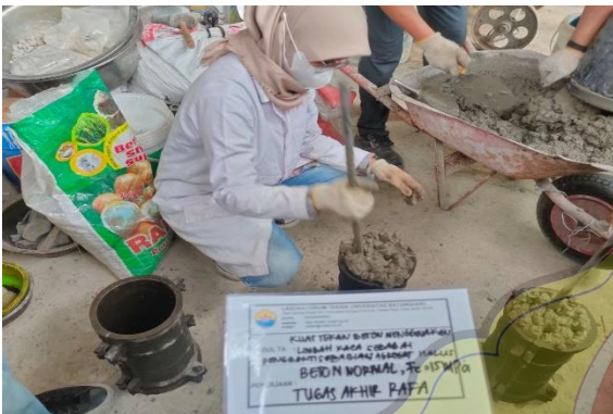
Proses Perojokan Beton Normal
