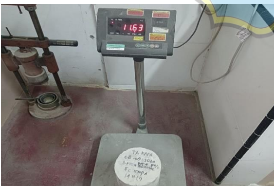
Penimbangan Berat Benda Uji Beton Kaca 8% 14H (1)
