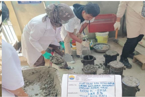
Memasukan Beton Kaca 8 % Ke Dalam Cetakan Silinder
