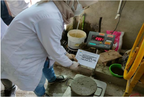
Proses Pengujian Berat Isi Beton Normal
