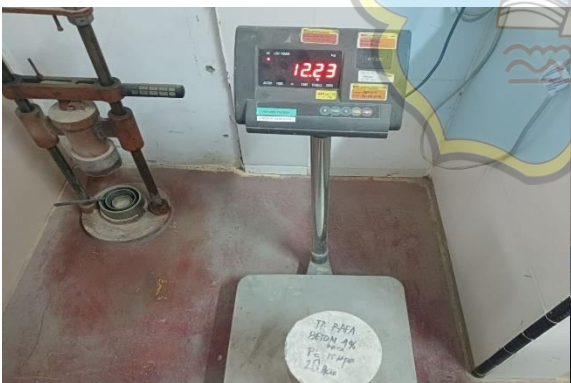
Penimbangan Berat Benda Uji Beton Kaca 4 % 28H (2)
