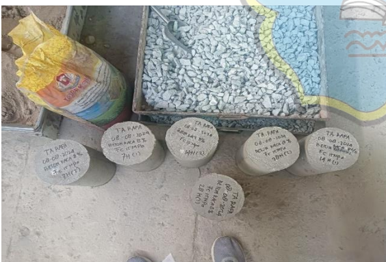
Menunggu 24 jam Hingga Beton Mengeras Dan Dikeluarkan Dari Cetakan
