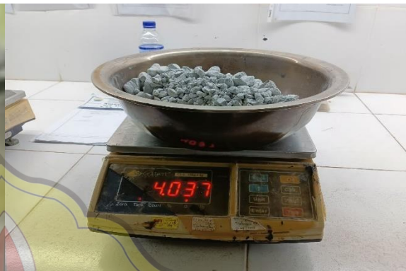
Proses Penimbangan Agregat Yang Telah Kering
