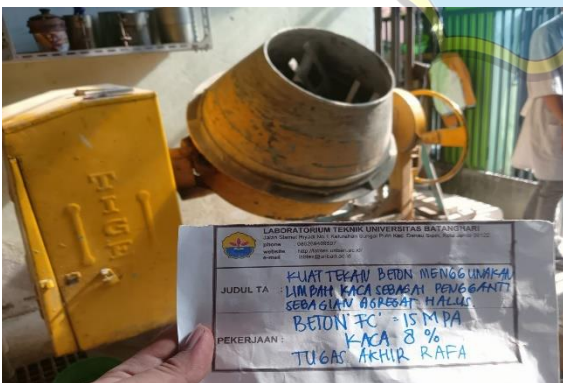
Pengadukan Beton Pengadukan Beton Segar Menggunakan Mesin Molen
