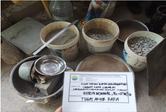
Proses Penyiapan Material Untuk Pengecoran Beton Normal
