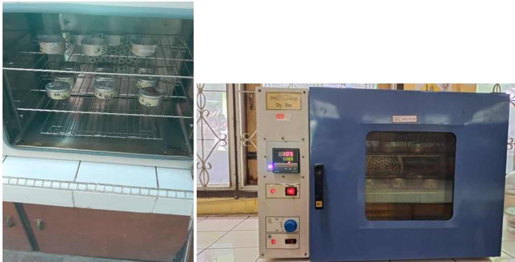
Gambar 32 Pengukuran kadar air biji kopi dan biji jagung pipil
