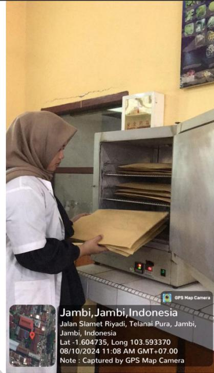
Gambar 21. Pengovenan tanah untuk mengetahui kadar air media
