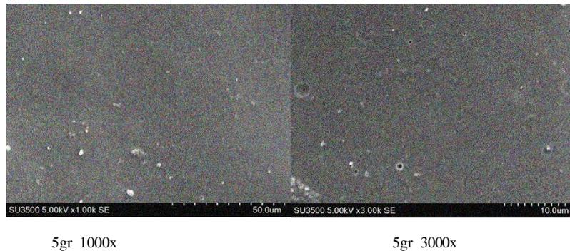
Gambar 4.5 Hasil uji SEM Membran Ultrafiltrasi dengan konsentrasi larutan kitosan 5gr
