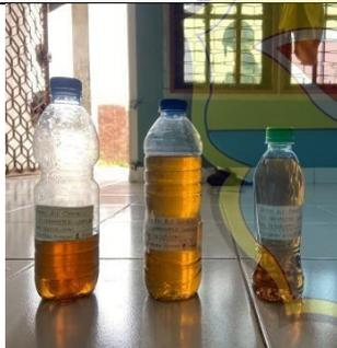
Hasil dari proses ultrafiltrasi membran variasi 1 gr, 3 gr dan 5 gr
