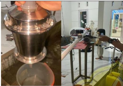
Pengaplikasian membran ultrafiltrasi dengan alat ultrafiltrasi metode dead-end.
