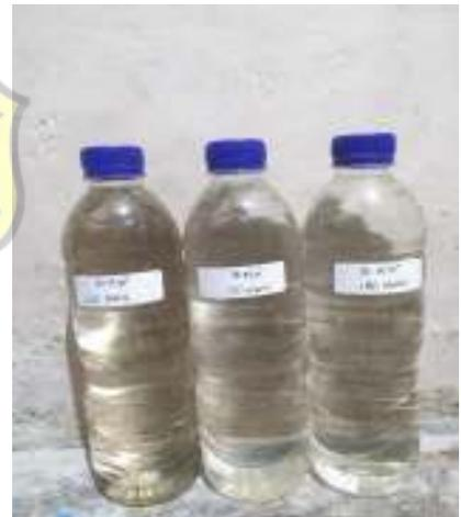
Gambar 10. Air limbah setelah pengolahan dengan perlakuan  $180 \text{ A/m}^2$  dengan waktu 60 menit, 120 menit, 180 menit
