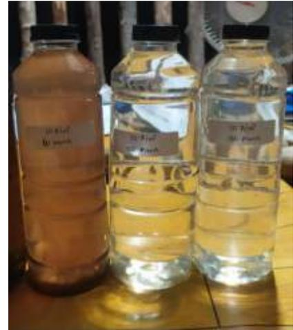
Gambar 8. Air limbah setelah pengolahan dengan perlakuan  $10 \text{ A/m}^2$  dengan waktu 60 menit, 120 menit, 180 menit
