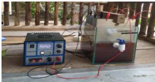
Gambar 3.3 Reaktor elektrokoagulasi
