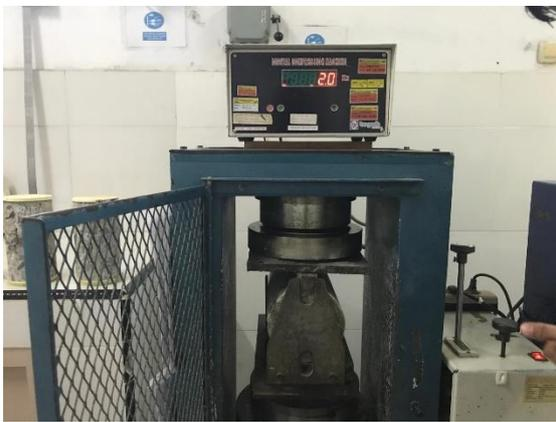
Benda uji silinder No.5 sebelum dilakukan uji kuat Tarik belah
