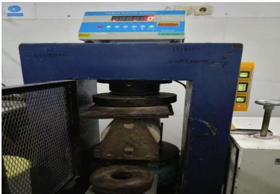
Benda uji silinder No.1 sebelum dilakukan uji kuat Tarik belah
