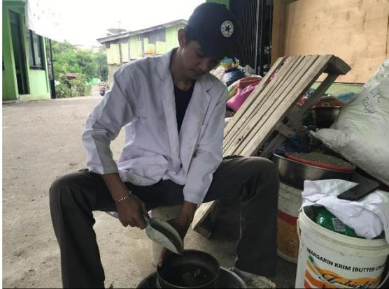
Proses memasukkan agregat halus ke dalam Saringan yang telah tersusun
