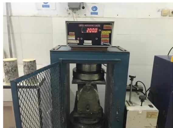
Benda uji silinder No.5 setelah dilakukan uji kuat Tarik belah
