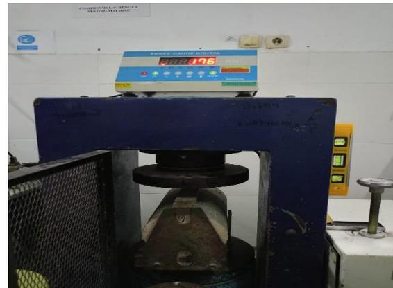
Benda uji silinder No.2 setelah dilakukan uji kuat Tarik belah
