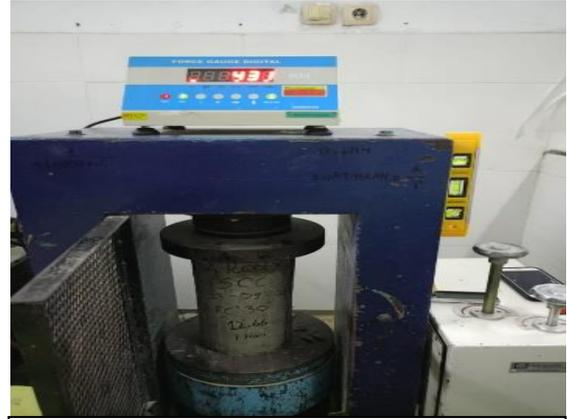
Benda uji silinder No.1 setelah di uji tekan
