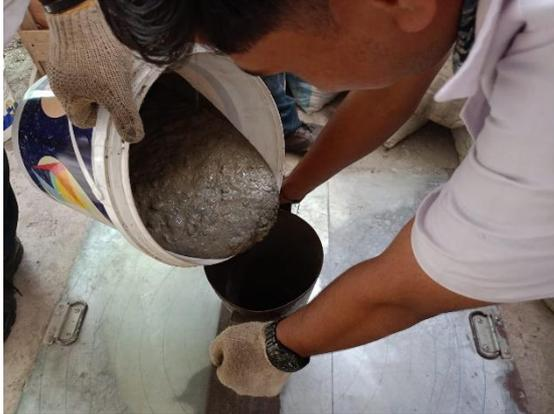
Proses pengujian Slump flow
