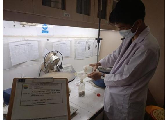
Tuangkan cairan NaOH kedalam botol kaca yang telah diisi agregat halus
