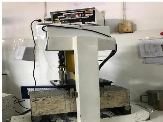
Benda uji balok No.2 sebelum dilakukan uji lentur
