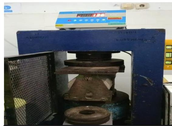
Benda uji silinder No.3 setelah dilakukan uji kuat Tarik belah
