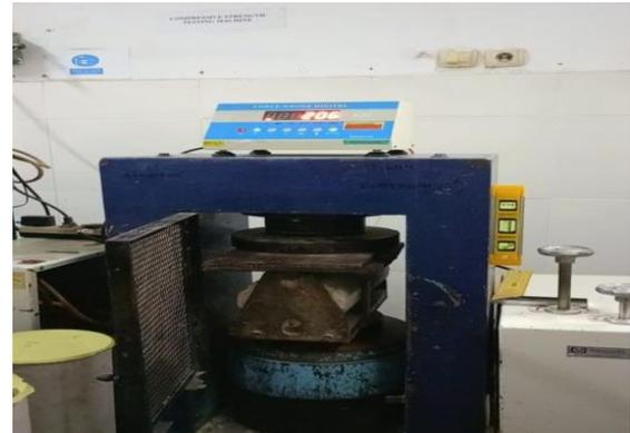
Benda uji silinder No.1 setelah dilakukan uji kuat Tarik belah
