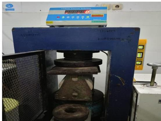
Benda uji silinder No.2 sebelum dilakukan uji kuat Tarik belah
