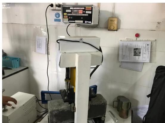
Benda uji balok No.3 sebelum dilakukan uji lentur
