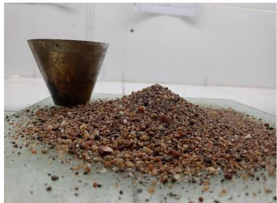
Runtuhan hasil pengujian penyerapan agregat halus
