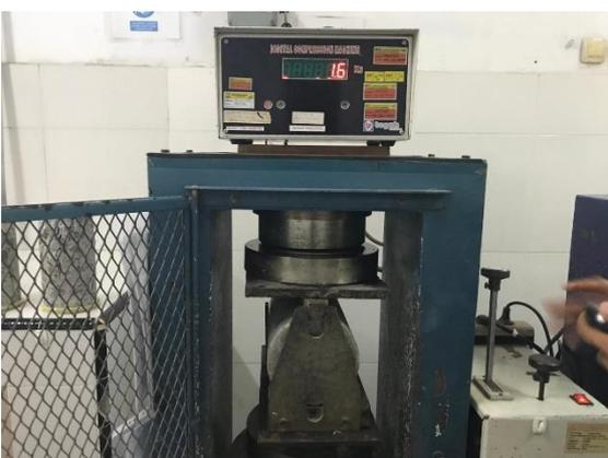
Benda uji silinder No.6 sebelum dilakukan uji kuat Tarik belah
