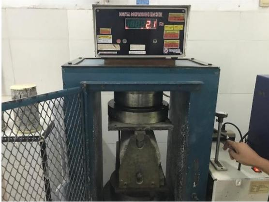
Benda uji silinder No.4 sebelum dilakukan uji kuat Tarik belah
