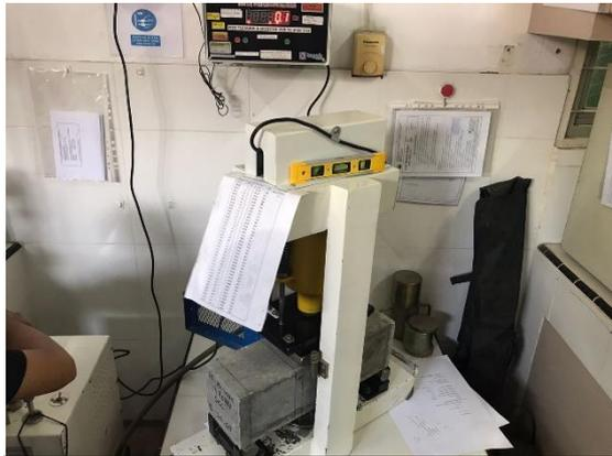
Benda uji balok No.5 sebelum di lakukan uji lentur
