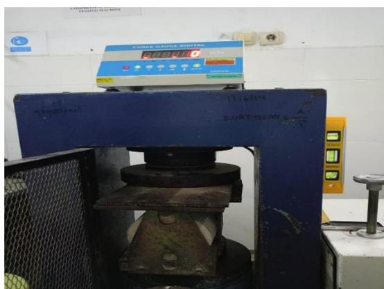
Benda uji silinder No.3 sebelum dilakukan uji kuat Tarik belah
