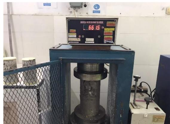
Benda uji silinder No.6 setelah di uji tekan
