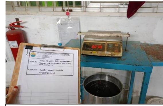
Proses timbang agregat halus di dalam air
