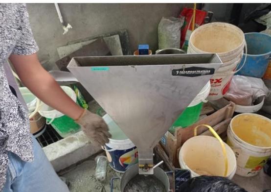
Pengujian V-Funnel Test
