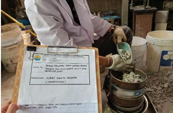
Proses memasukkan agregat kasar ke dalam Saringan yang telah tersusun
