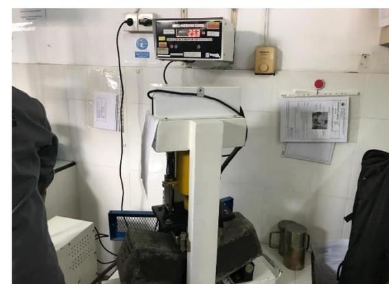
Benda uji balok No.3 setelah dilakukan uji lentur
