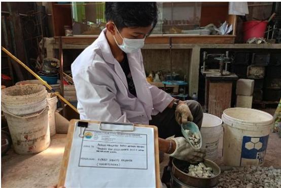
Proses memasukkan agregat kasar ke dalam Saringan yang telah tersusun
