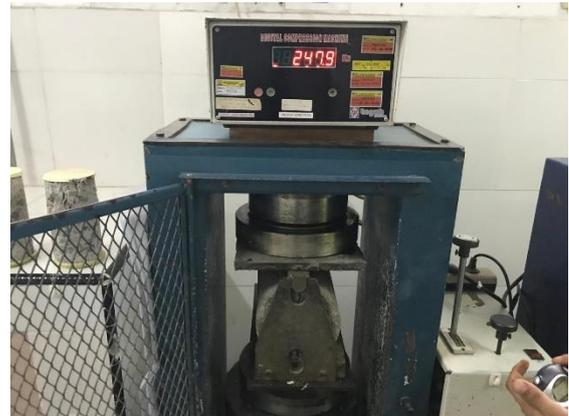
Benda uji silinder No.4 setelah dilakukan uji kuat Tarik belah
