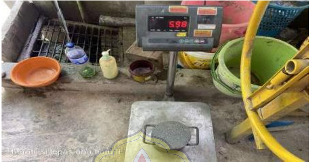
Gambar 9. Pengujian Berat Isi Lepas Abu Batu
