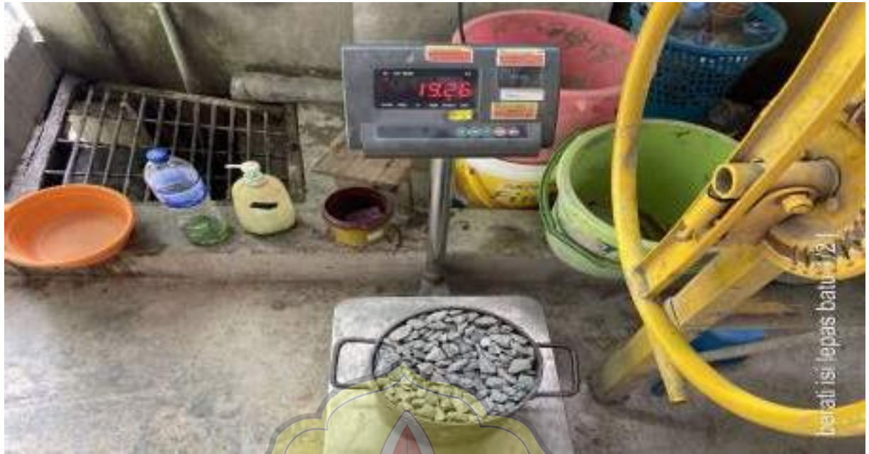
Gambar 5. Pengujian Berat Isi Lepas Batu 1-2
