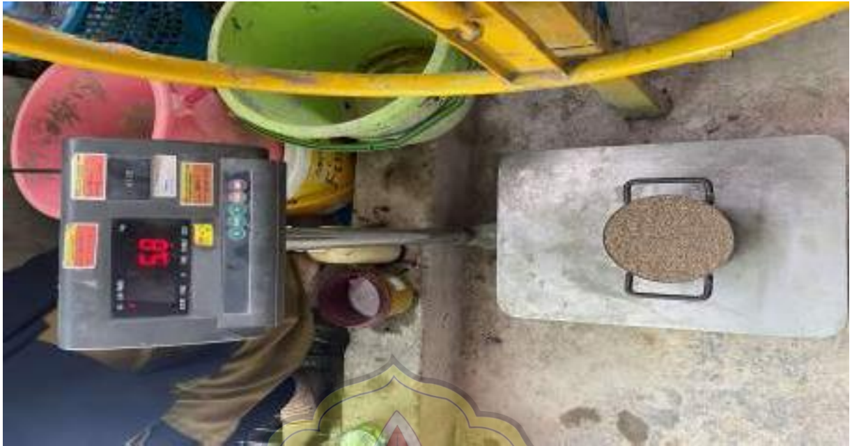
Gambar 11. Pengujian Berat Isi Lepas Pasir
