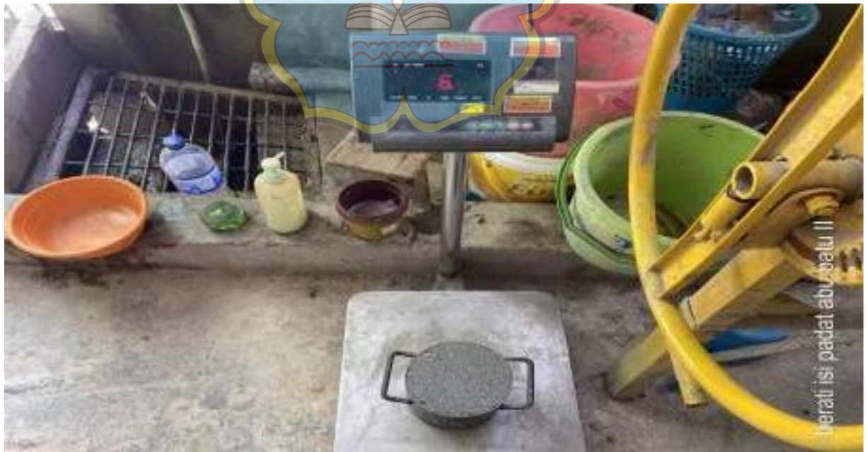
Gambar 10. Pengujian Berat Isi Padat Abu Batu
