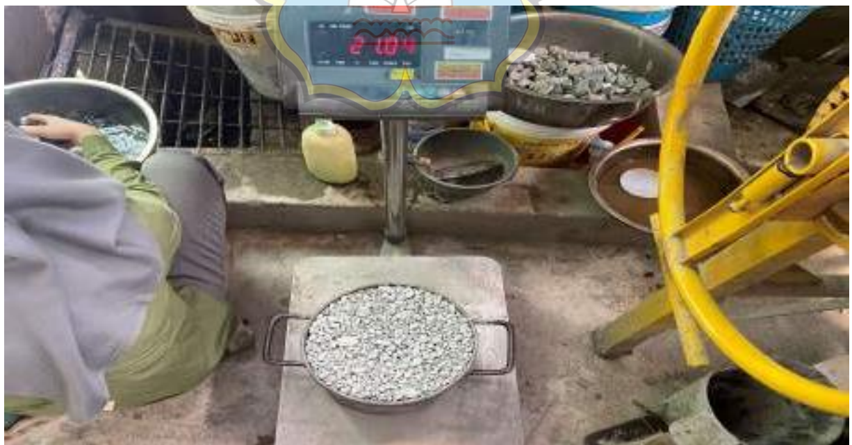
Gambar 6. Pengujian Berat Isi Padat Batu 1-2
