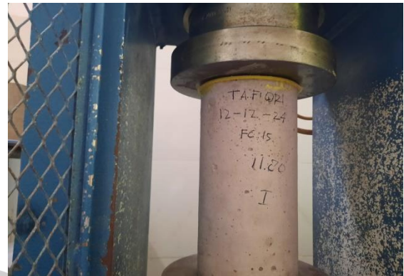
Benda Uji Silinder Sebelum Diuji Tekan
