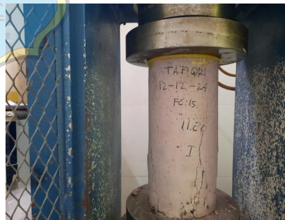
Benda uji silinder setelah diuji tekan
