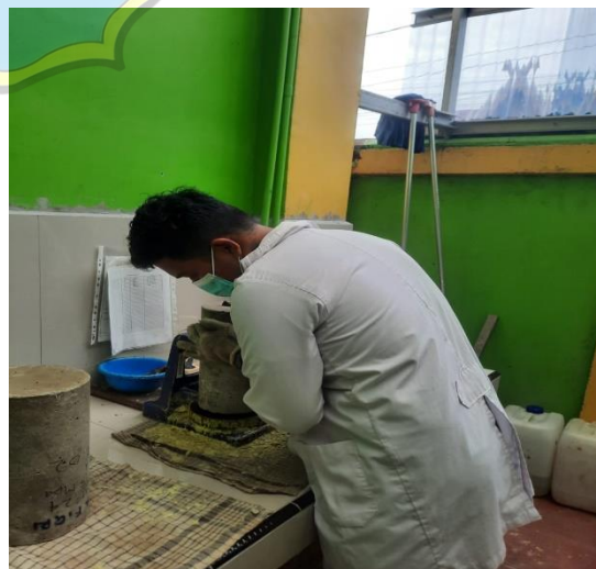
Proses pengangkatan benda uji dari kecetakan
