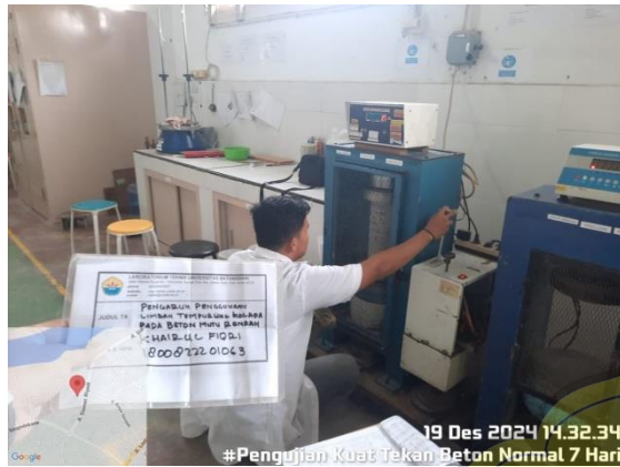
Proses Pengujian Kuat Tekan
