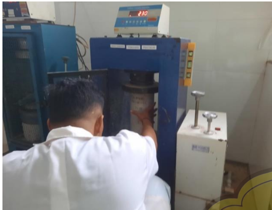
Proses Pengujian Kuat Tekan
