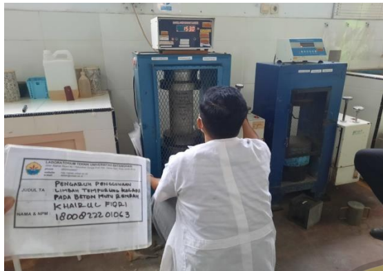
Proses Pengujian Kuat Tekan
