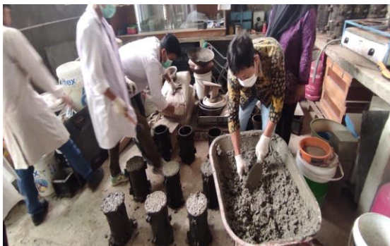
Proses penuangan adukan ke cetakan silinder
