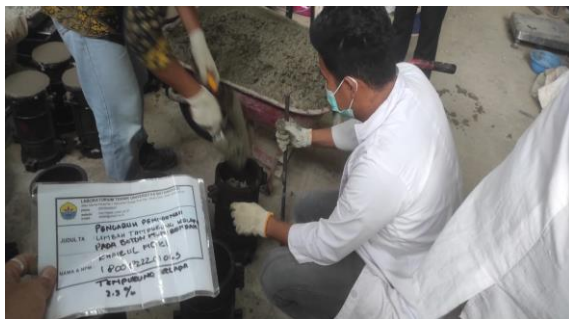
Proses penuangan adukan ke cetakan silinder
