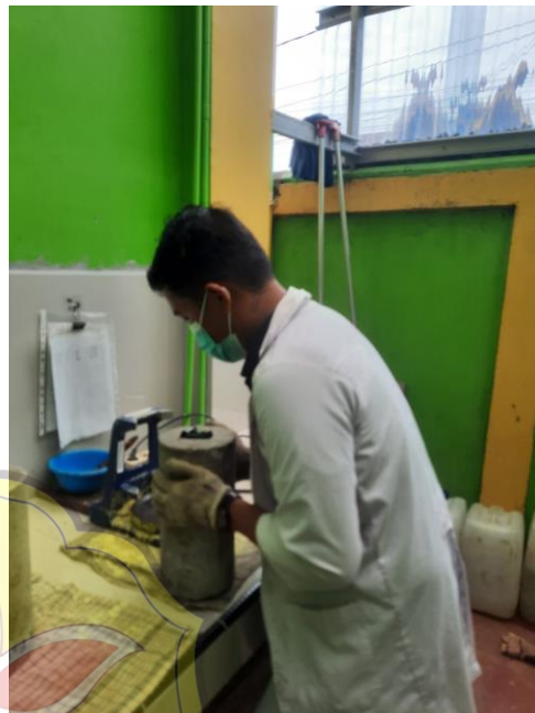
Proses pengangkatan benda uji kecetakan
