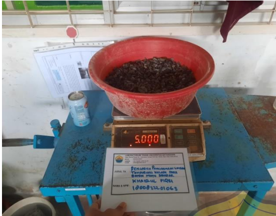
Timbang agregat kasar yang telah di rendam selama 24 jam
