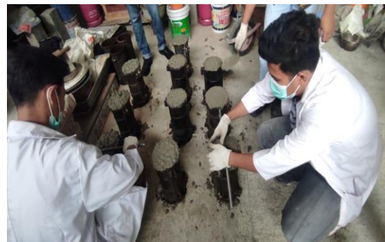
Proses pembuatan benda uji silinder
