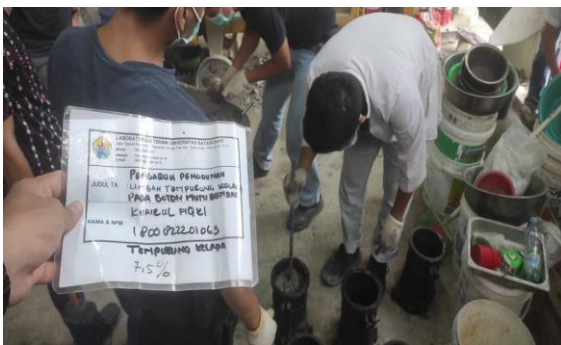
Proses penuangan adukan ke cetakan silinder
