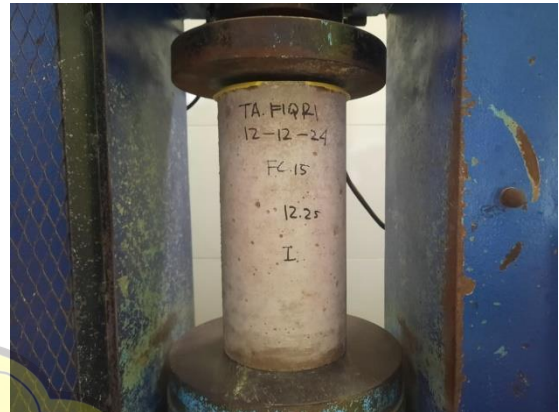
Benda Uji Silinder Sebelum Diuji Tekan
