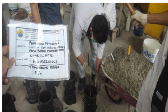
Proses pembuatan benda uji silinder
