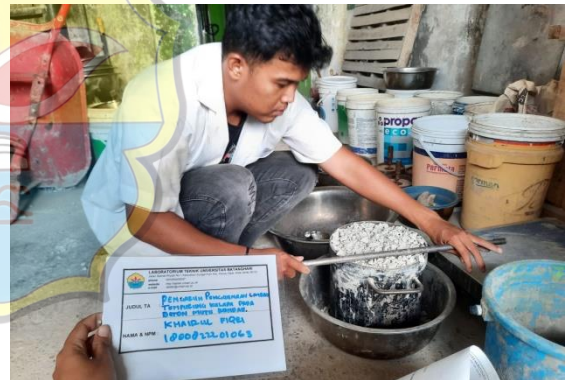
ratakan agregat menggunakan rojokan
