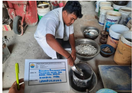
Masukan agregat kasar kedalam wadah dan isi agregat 1/3 wadah
