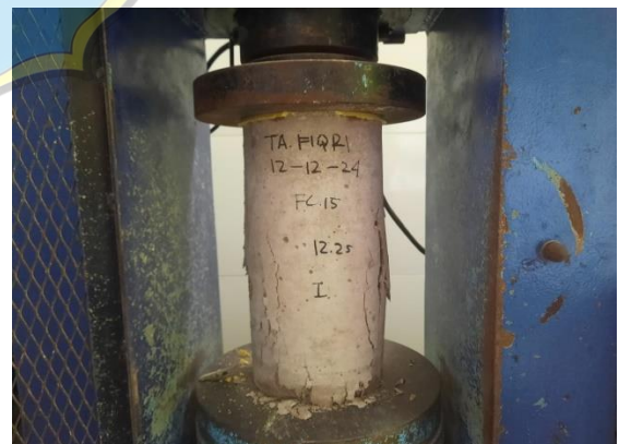
Benda uji silinder setelah diuji tekan
