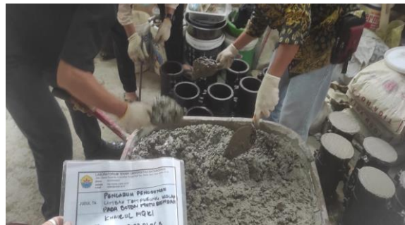
Proses pembuatan benda uji silinder
