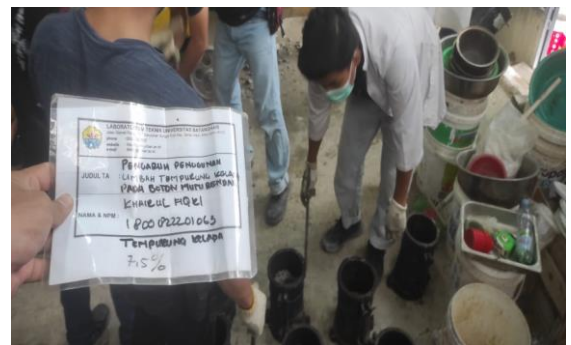
Proses pembuatan benda uji silinder
