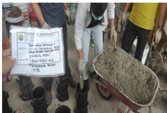
Proses penuangan adukan ke cetakan silinder
