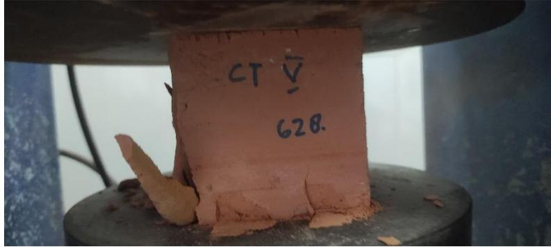
Gambar 3.9 Pengujian Kuat tekan Bata Merah
