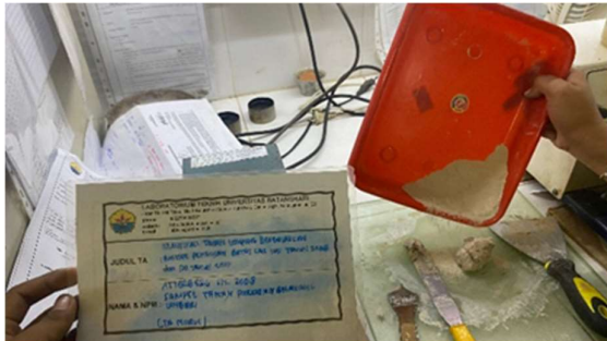
Proses pencampuran sampel batas plastis
