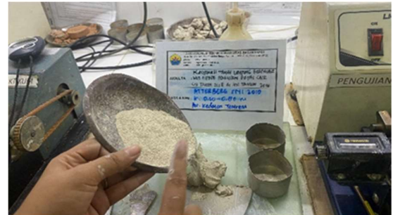
Proses pencampuran sampel batas plastis
