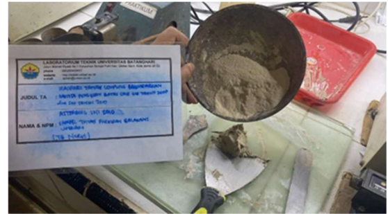
Proses pencampuran sampel batas plastis
