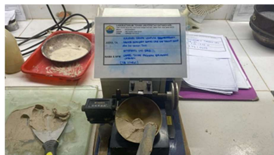
Adonan pasta dimasukkan kedalam mangkok casagrande
