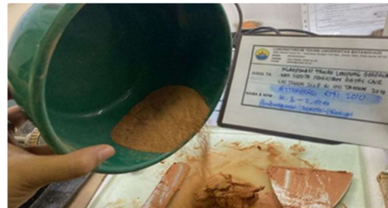
Proses pencampuran sampel batas plastis
