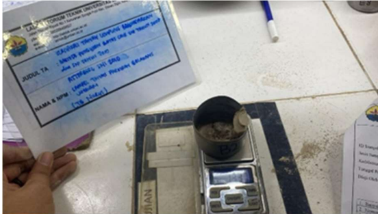
Proses pencampuran sampel batas plastis
