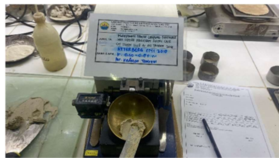
Proses memasukkan sampel ke mangkok casagrande
