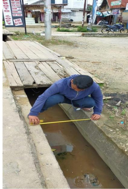
Gambar. Survey Pengukuran Drainase
